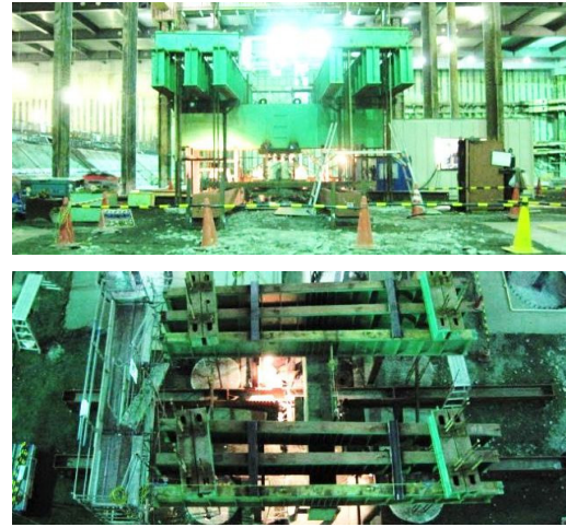
写真)載荷装置組立
