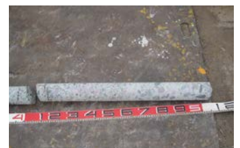
写真4 杭先端部コア
