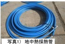
写真1) 地中熱採熱管
