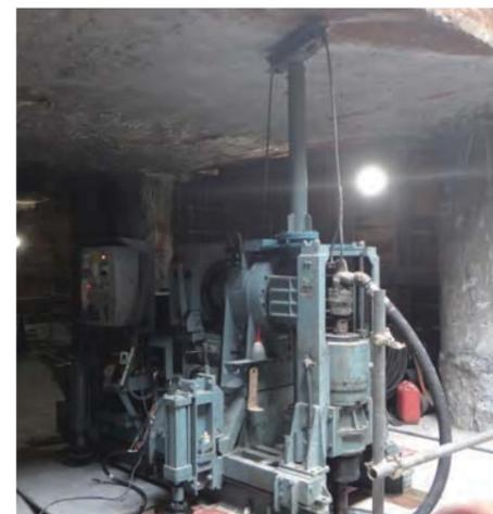
BH 工法および TBH 工法は大口径ボーリング機械により掘削を行います
