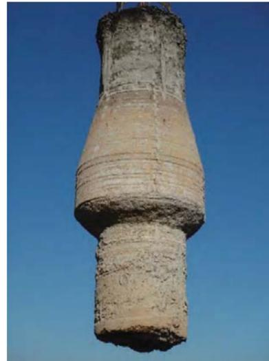
軸部径 φ1,000mm 拡径径 φ1,500mm
